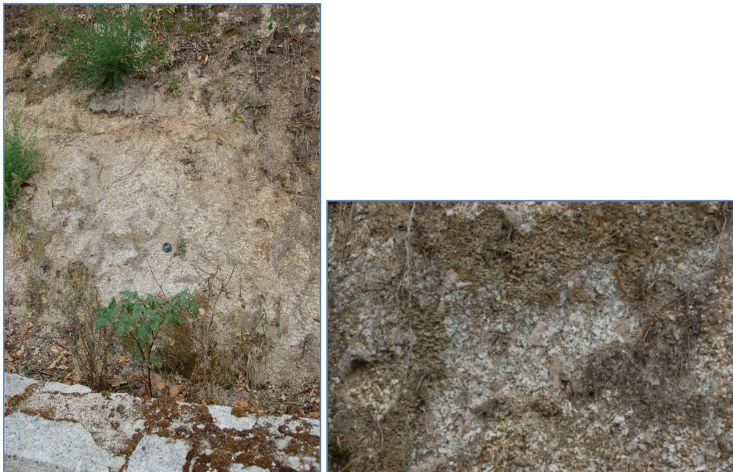
Fotografia 7 a-b. Affioramento di monzograniti inequigranulari in facies da sub-litoide a leggermente alterata, coesivi (Via Togliatti).
